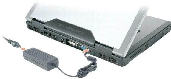
Das Netzteil wandelt Wechselstrom in den vom Computer benötigten Gleichstrom um. Sie können das Netzteil bei ein- oder ausgeschaltetem Computer anschließen. Um die beste Leistung zu erzielen, sollten Sie nur das Netzteil benutzen, dass mit dem Computer geliefert wurde.
