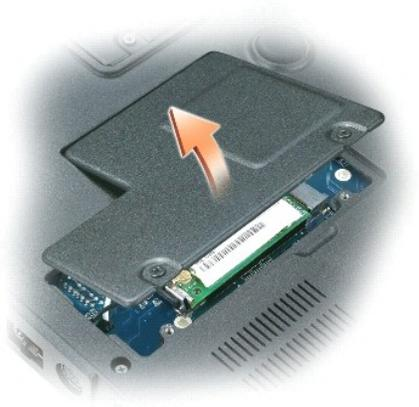
4. Falls noch keine Mini-Card installiert ist, fahren Sie mit [Schritt 5](#) fort. Wenn Sie eine Mini-Card austauschen, entfernen Sie zunächst die alte Karte:
