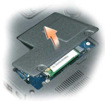
4. Entfernen Sie das alte Modem:
