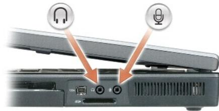
Schließen Sie an den mit dem Symbol
